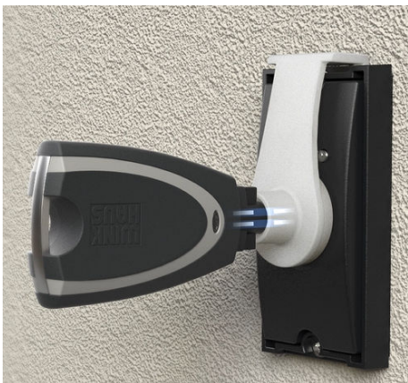
Abb. 127: Programmieradapter einhängen und Masterkey einstecken
